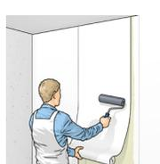
10. Innen-Dämmplatten sind ohne Armierung mit allen rissüberbrückenden, diffusionsoffenen Wandbelägen überklebbar. Bei nicht rissüberbrückenden Wandbelägen, wie z. B. Papiertapeten, ist eine vor-herige Armierung mit Rissband oder eine vollflächige Armierung notwendig.
