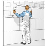
6. Innen-Dämmplatte übereinanderversetzt (mind. 20 cm) mit mäßigem Druck an die Wand anpressen. Kreuzfugen und Lücken vermeiden. Überschüssigen Kleber an den Rändern entfernen.
